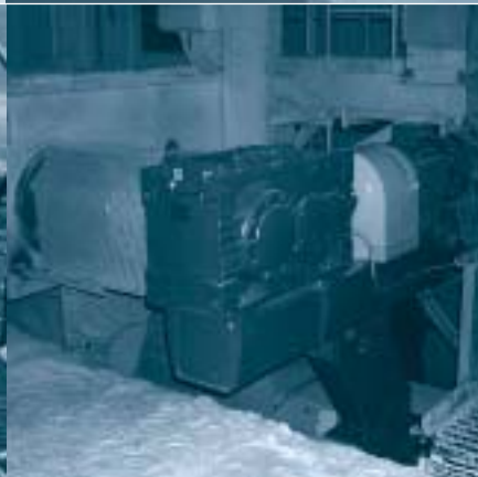
Juostinio konvejerio pavara su MC serijos reduktoriumi
